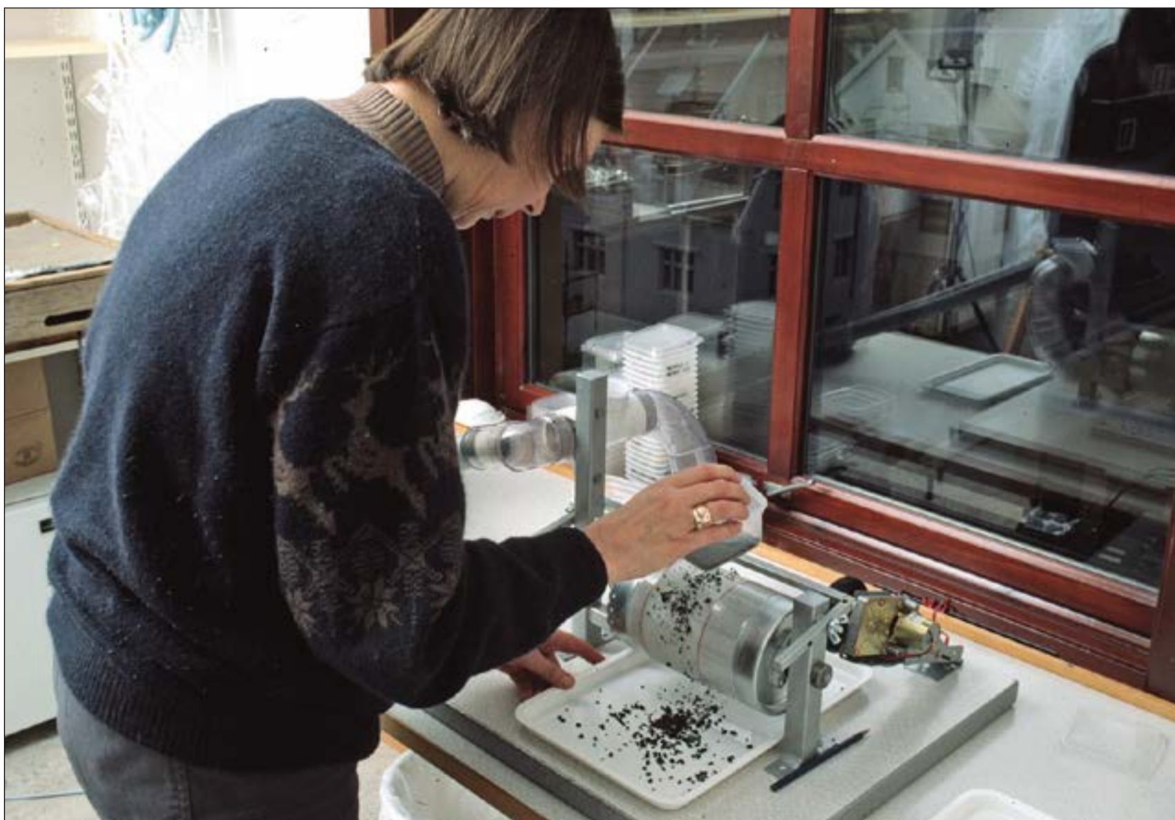
Separering av trekull ved bruk av maskinell teknologi. Laborant Tamara Virnovskaia i sving med AmS-trekullseparatoren utviklet av botaniker Sverre Bakkevig. Foto: Terje Tveit. Arkeologisk museum, Universitetet i Stavanger ©.
