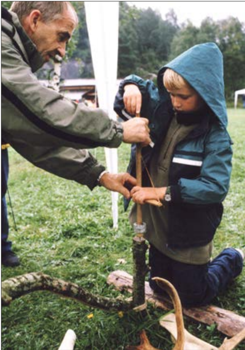
I vår tid gir aktivitetsdager og rekonstruerte redskaper en fin anledning til å prøve fortidens arbeidsoppgaver. Her bores det med en pumpedrill. Foto: Terje Tveit.
