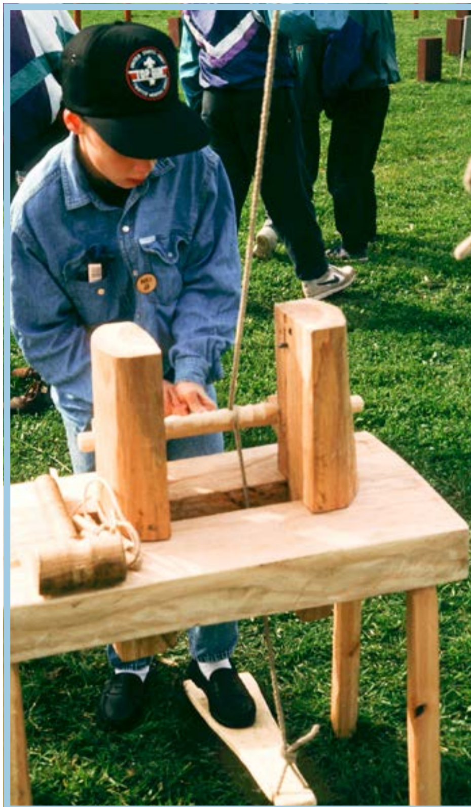
Rekonstrert dreiebenk. Slike var trolig i bruk i jernalderen. Foto: Sverre Bakkevig.
