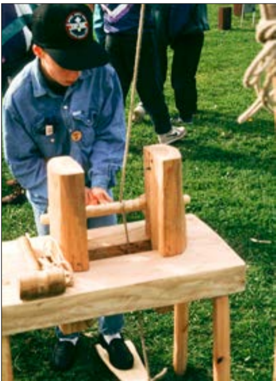
Demonstrasjon av en rekonstruert dreiebenk. Den har snordrift og kan drives med foten, eller med en bue som føres frem og tilbake. Foto: Sverre Bakkevig.
