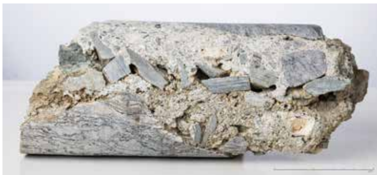
Fig. 5. En kjerneprøve av den romanske grunnmuren, tatt i sammenheng med installasjon av nye rør, bidrar til informasjon om murens konstruksjon og inneholder blant annet ubrent skjell, kull, bein og klumper av ulesket kalk. Legg merke til at vi, på bakgrunn av farge og tekstur, kan identifisere to forskjellige mørtler. Foto: Annette Græsli Øvreli, AM.
